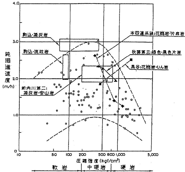
(イ) 岩盤等級とTBMの純掘進速度の関係
